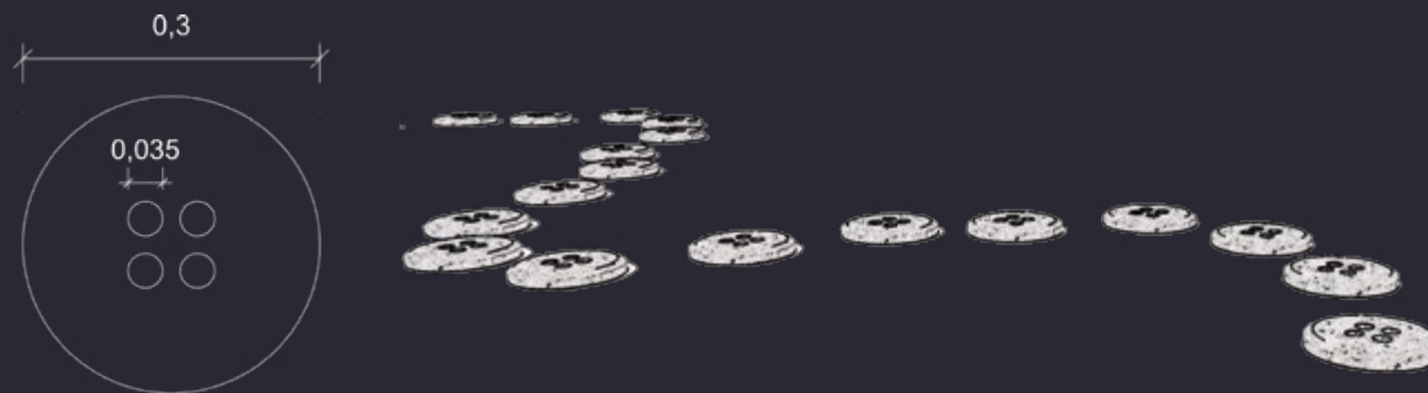
Ilustración. Prefabricado en Botón. Unidades en metros.
