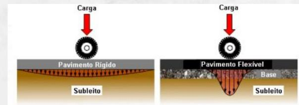
Las cargas producidas por la volqueta, a través de sus llantas, se distribuyen homogéneamente en el pavimento o el suelo
